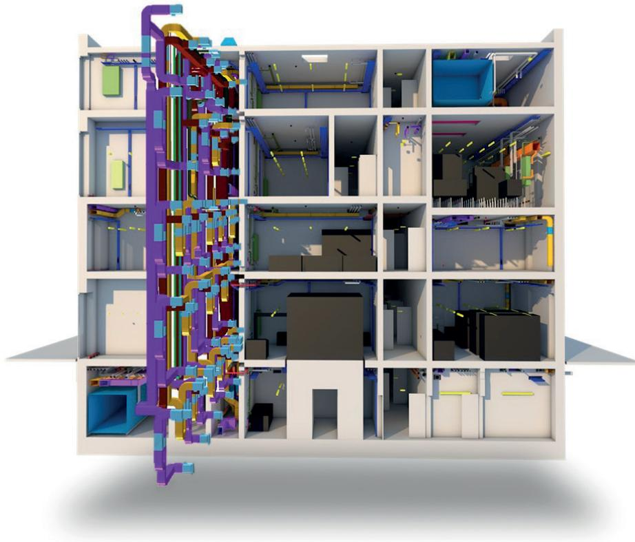
Abb. 1: Gebäudequerschnitt mit Lüftungskanal-Isometrie
