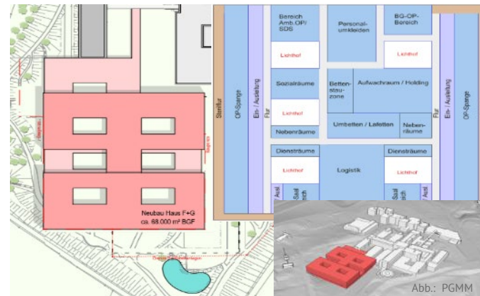
Robert-Bosch-Krankenhaus – Zentral-OP mit Logistikkonzept in Neubau Funktionsgebäude
